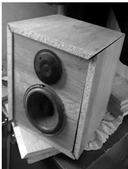
Rysunek 3.9. Elementy konstrukcyjne głośnika przed ostatecznym sklejeniem
