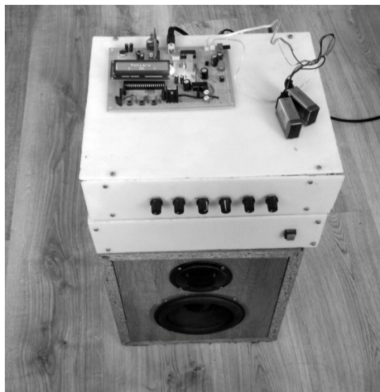
Rysunek 3.24. Zestaw do pomiarów akustyki pomieszczeń
