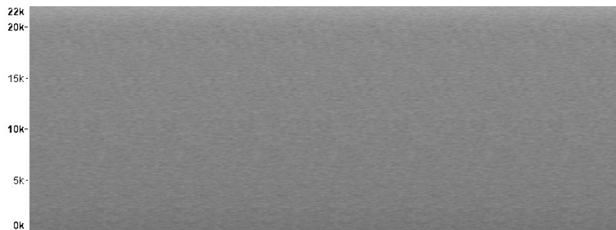
Rysunek 3.20. Widmo częstotliwościowe szumu białego
