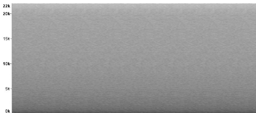
Rysunek 3.21. Widmo częstotliwościowe szumu różowego
