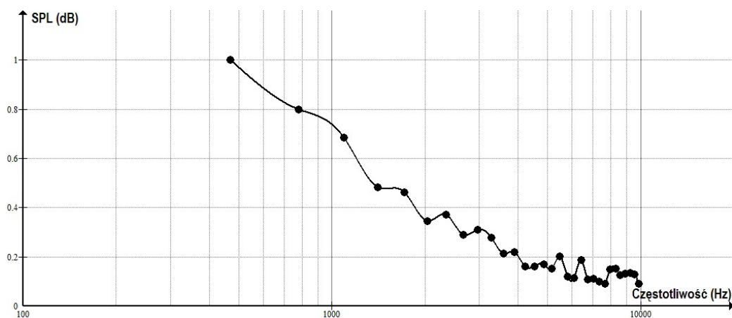
Rysunek 3.27. Wyniki pomiaru pasma przenoszenia subwoofera
