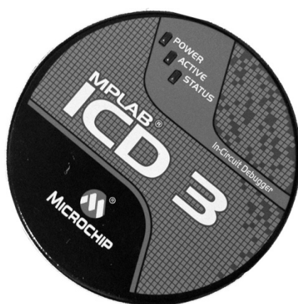
Rysunek 3.13. Programator mikrokontrolerów używany podczas pracy
