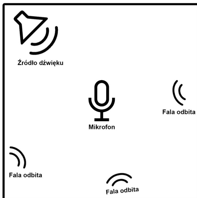
Rysunek 2.22. Schemat ideowy pomiaru akustyki pomieszczenia
